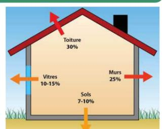
Répartition des pertes d'énergie sur le bâti non isolé : l'amélioration la plus importante des performances thermiques s'obtient par le renforcement de l'isolation de la toiture.
